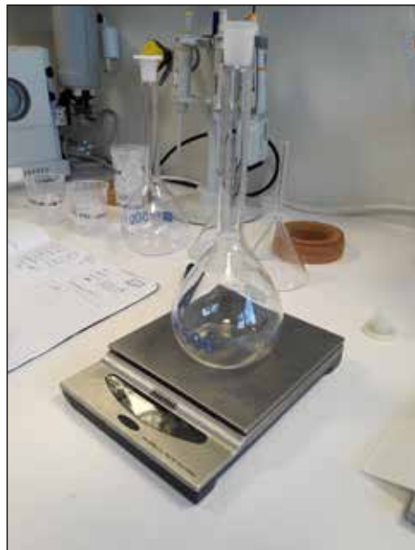
Wiegen des Messkolbens leer...
