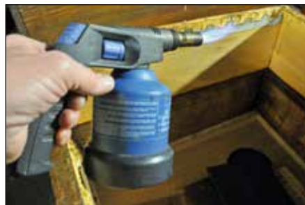
Ausbrennen mit dem Gasbrenner © Bourkel
