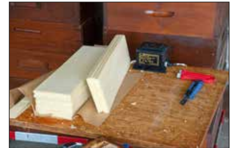
Alles was man zum Einlöten braucht. MW, Trafo, scharfes Messer und Drahtspanner © Bourkel
