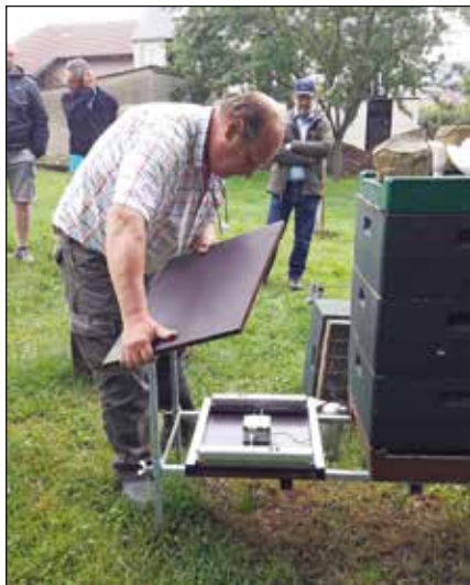
Stockwaagen sind installiert © Eickermann
