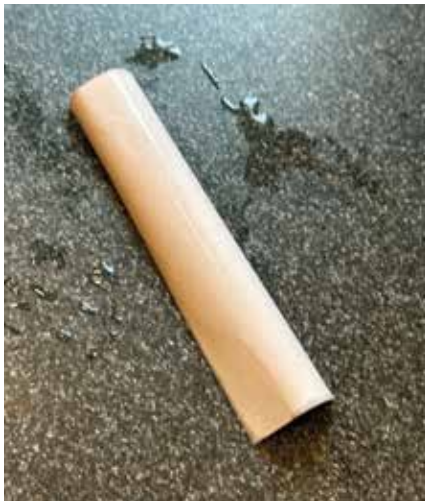
© Schroeder: Wird Papier einseitig mit Kleister bestrichen, rollt es zusammen
