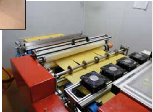
© Gidt Mittelwandherstellung aus eigenem Wachs auf beiden Anlagen.
