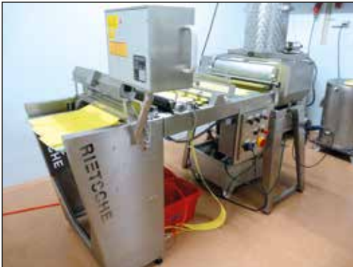
© Gidt Mittelwandherstellung aus eigenem Wachs auf beiden Anlagen.
