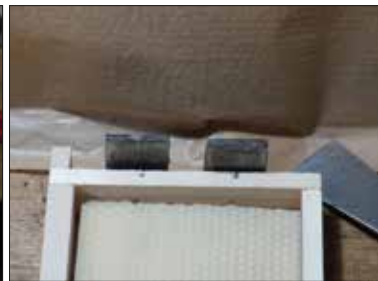
© Jungels - Leicht anheben und gegen die Kontakte des Einlötergerätes drücken.
